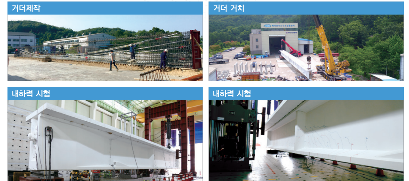
* 실물 거더 시험 결과 설계 휨 모멘트를 25% 상회 하는 것으로 나타남.
